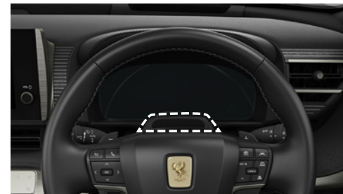
ドライバーモニターカメラ ■ドライバーモニターカメラで運転者が周囲の状況を確認し、運転操作できる状態であるかシステムが判断します。システムが運転操作ができない状態と判断した場合は、プザーとディスプレイ表示で注意喚起を行います*2。
